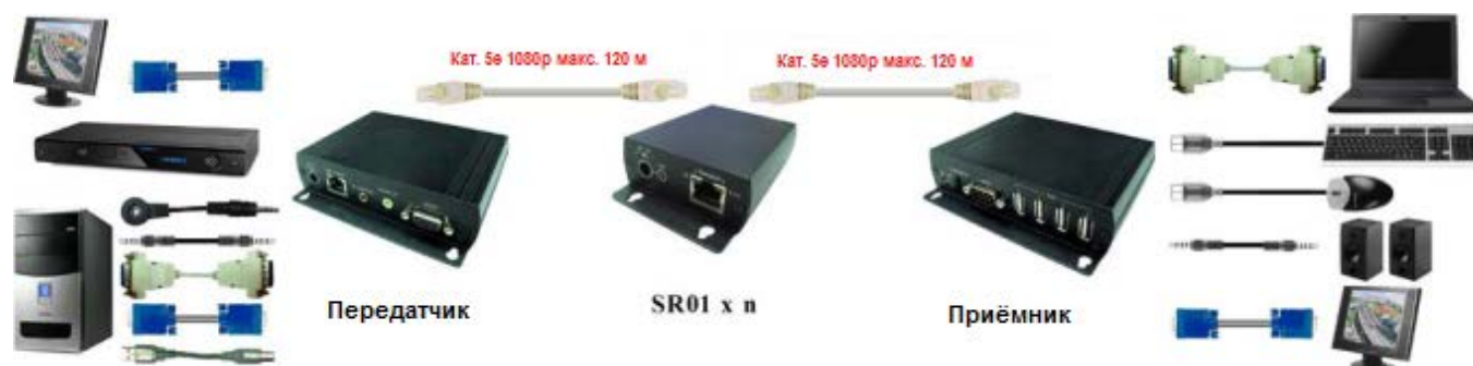
Рис. 5 Схема подключения SR01 совместно с VKM03.
