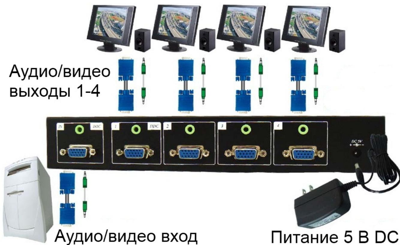
Рис. 3 Схема подключения VD04A.
